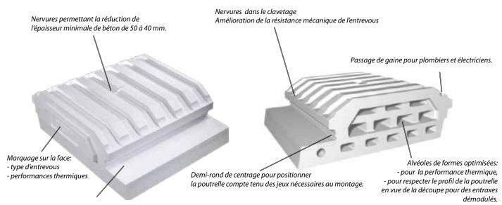
Epaisseur de languette: 78 mm pour l'isoleader 27. Le profil extérieur permet la mise en place sans blocage en assurant le contact entre deux entrevous pour une meilleure performance thermique.
