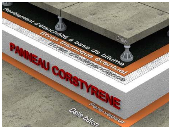
Revêtement à base de bitume (schéma 3-3)
