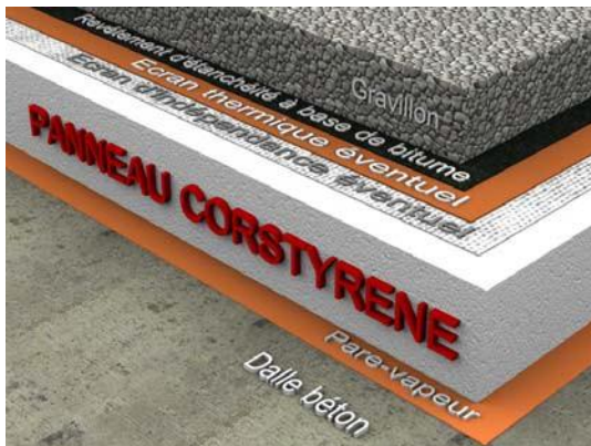
Revêtement à base de bitume (schéma 3-1)
