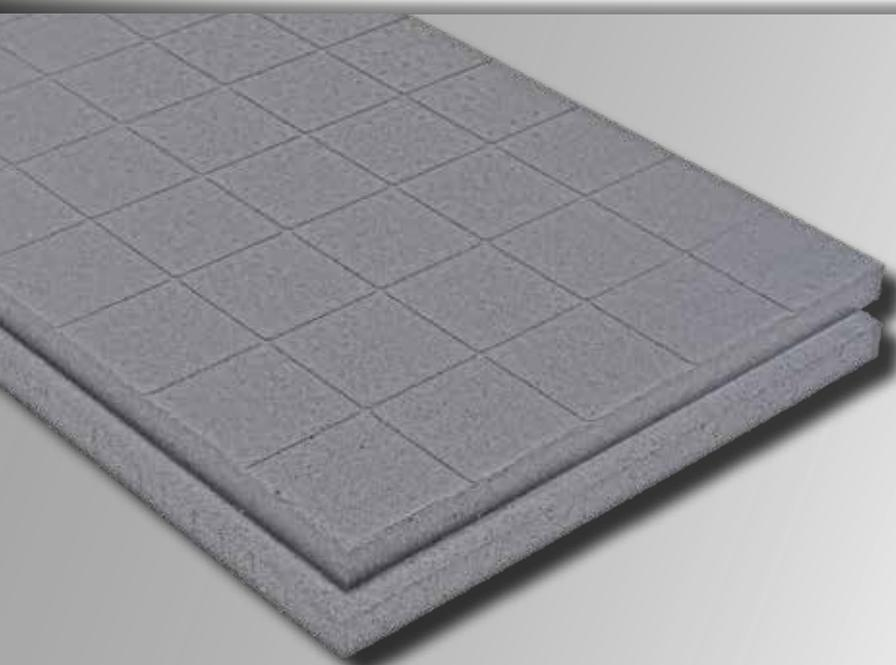
**CORSTYRENE SOL ULTRA** est un panneau moulé en polystyrène expansé graphité Th31. Ce produit est utilisé pour l'isolation en partie courante des sols sous chape et sous dallage. De forte densité, il répond aux exigences techniques et thermiques des isolants sous chape flottante avec ou sans système de chauffage intégré.
