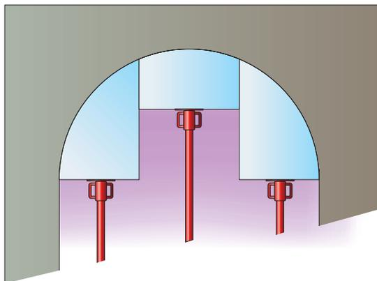
Pour la réalisation de cintres de grande portée, la fabrication de moules en "pièces détachées" rend aisé les manipulations sur chantier et facilite ainsi la mise en œuvre.
